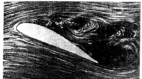
Tako ponazarjajo v aerodinamičnih laboratorijih zračni tok okrog krilnega profila. Ker ima krilni profil prevelik vpadni kot, se je zračni tok na zgornji strani odlepil; začeli so se tvoriti vrtinci.
