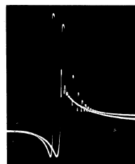
Bild 14: Hauptresonanz eines 1 MHz-Quarzes; Kurve links: f_M = 4 Hz; Kurve rechts: f_M = 12 Hz; f_H = 6 kHz
