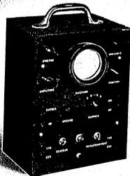
Les performances énumérées dans les pages précédentes sont mesurables par tout technicien en Radiologie au moyen du Controlix, oscillographe portatif de contrôle spécialement conçu pour l'examen rapide et précis de tout meuble de commande.
