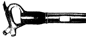
Рис. 26. Общий вид рубильно-чеканного молотка РБ-63
