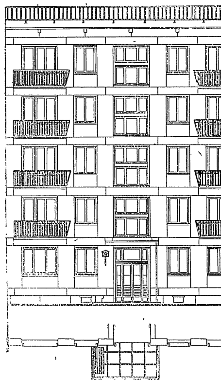
Рис. 4. Фрагмент разрезки наружной стены дома.
