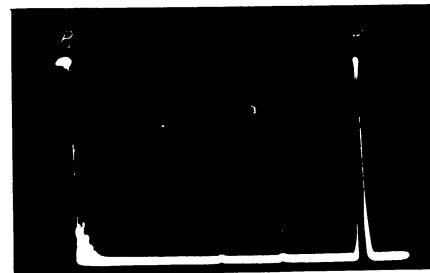
Abbildung 33b Tripelspiegel 20 m vor dem Haus Funkmeßgerät: Einstellung wie Abbildung 33a dazu AC_S = 5 und VH = 5 . Durch zeitabhängige Zurücknahme der Verstärkung AC_S werden - trotz höherer Gesamtverstärkung - die Echos der Nebenziele einschl. des Hausechos vor und hinter dem Tripelspiegelecho unterdrückt
