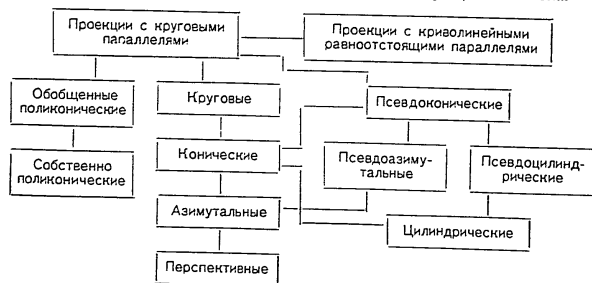
Схема классификации картографических проекций по виду нормальной сетки
