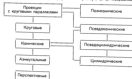
Схема классификации картографических проекций В. В. Каврайского
