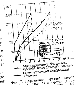
Фиг. 7 Деформация передней направляющей (в точке 16) и каретки (в точке 15) в вертикальной плоскости от действия силы P .
