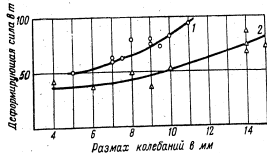
Фиг. 6. Зависимость деформирующей силы от размаха и частоты колебаний. 1—800—990 кол/мин; 2—400—450 кол/мин.
