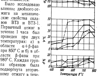
Fig. 3. Влияние отпуска в течение 1 часа на механические свойства сплавов ВТЗ и ВТЗ-1.
