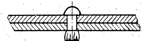
Bild 142: Mit zu leichtem Hammer genietet; Schließkopf wird hart und reißt an den Kanten ein
