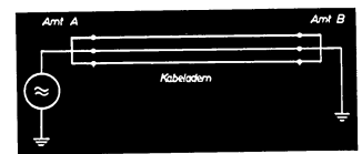
Bild 4. Schaltung beim Suchen eines Kabels unter mehreren
