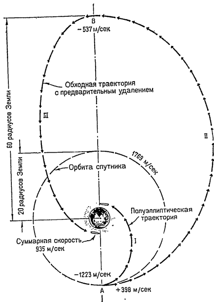
Рис. 49. Спуск с искусственного спутника на Землю по обходной траектории с предварительным удалением может значительно уменьшить расход необходимого топлива.
