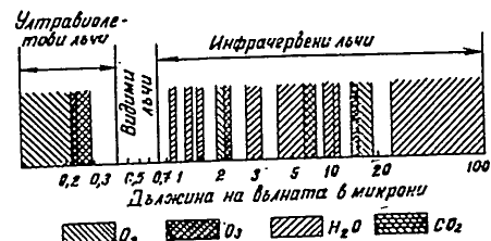
Фиг. 31. Ивици на поглъщане светлинното излъчване в атмосферата от кислорода, озона, водните пари и въгледвуокиса
