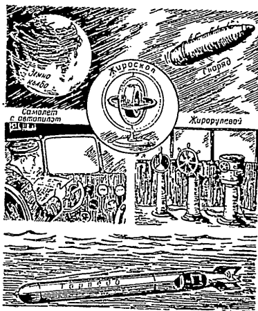
Фиг. 41. Забележителното свойство на бързо въртящия се пумпал да запазва посоката на оста си на въртенето се използва широко в техниката. Снарядът, въртейки се около оста си, лети с главата напред, без да се премия; торпедото благодарение на пумпала запазва дадената посока на движение; летецът може да се довери на автопилота, основна част в който е пумпалът, и да чете вестник; пумпалът заменя магнитните компаси на корабите; небесните тела — това са също така огромни пумпали
