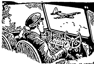
Фиг. 45. Летецът, управляващ радиосамолета, натиска бутона от таблото за управление. В далечината се вижда радиуправляваният самолет мишена
