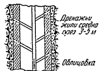
Фиг. 38. Дренажна система на галерия
