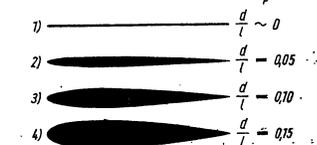
Bild 5. Polare symmetrischer Profile verschiedener Dicken
