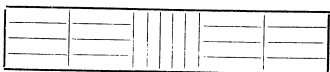
第六層兩側向裏收縮為橫置平放 4 \times 4 = 16 件，中間橫置平放6件，共計21件
