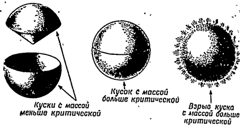
Рис. 41. Иллюстрация атомного взрыва при соединении двух кусков расщепляющегося материала, каждый из которых имеет массу, чуть меньшую критической массы
