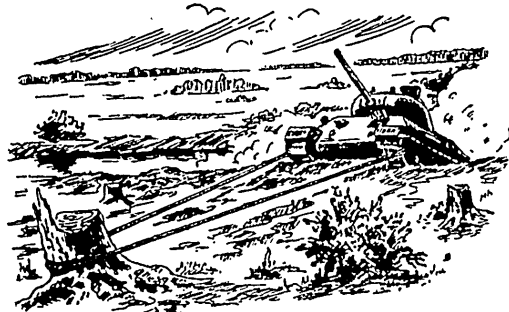
Рис. 54. Самоизвличане с помощта на въже, прикрепено към гъсениците и неподвижната основа ]
