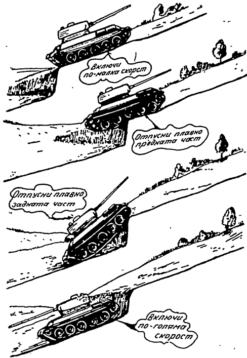
Рис. 22. Преодоляване на контраескарп
