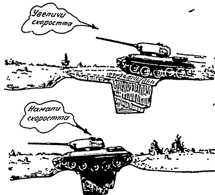
Рис. 26. Преодоляване на ров, по-широк от 0,3 от дължината на танка
