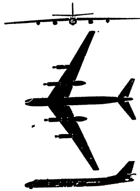
Tu-95, schweres Bombenflugzeug, 4-Propeller- Turbinen-Luft- strahltriebwerke mit gegenläufigen 8-Blatt- Luftschauben. Geschwindigkeit 800 bis 900 km/h. Flugweite 16 000 km
