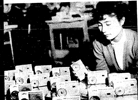
Tranzistorové rádio vyrobené v Japonsku má rozmery 112x71x32 mm a váži len 300 g. Na obrázku sú príjmače pripravené na odoslanie
