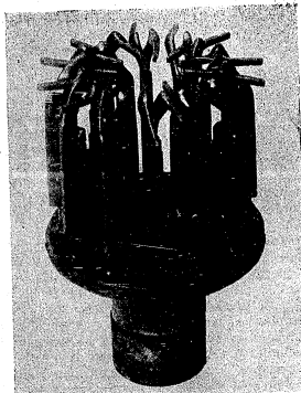
4. Stromečky dílců sestavené k odlévání metodou vytavitelného modelu: a - způsobem stacionárním; b - způsobem odstředivým do rotující formy
