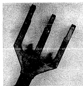
6. Odlitek vidlice tvarově shodné s dílcem vyráběným třískovým obráběním (žádné změny tvaru)
