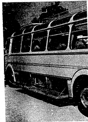
2. Priestor na odloženie batožiny
