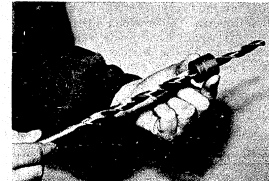
7. Prívrtak na skrutkový vrták, vyrobený elektroiskrovým spôsobom zo spekaného karbidu
