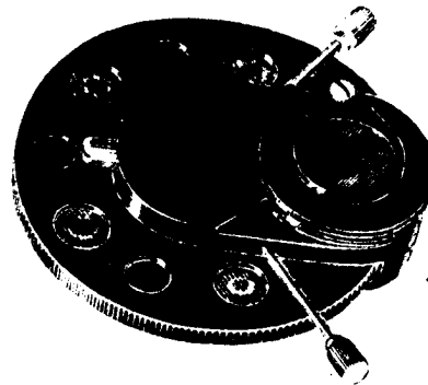
Рис. 29. Устройство КФ-1 для наблюдения препаратов методом фазовых контрастов
