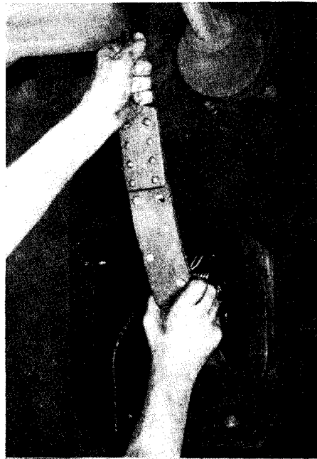
Abb. 41 Ausbauen des Bremsbandes
