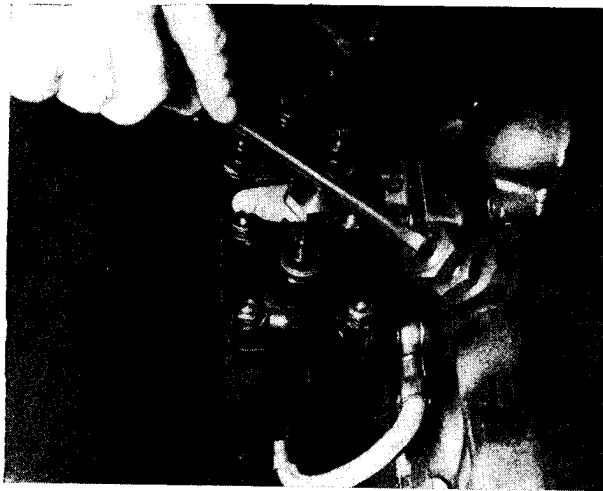
Abb. 34 Einstellen des Öldruckes am Überdruckventil
