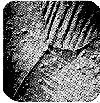
Рис. 5. Электронно-микроскопическое изображение поверхности деформированного циркония. Линии скольжения ( \times 5000 ).
