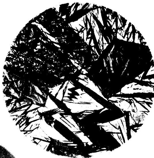
Рис. 33. — Сплав 26 — 1,68% С; 6,64% Al. Закалка в масле от 1160°С. Травление 2% ниталом 250 ×.
