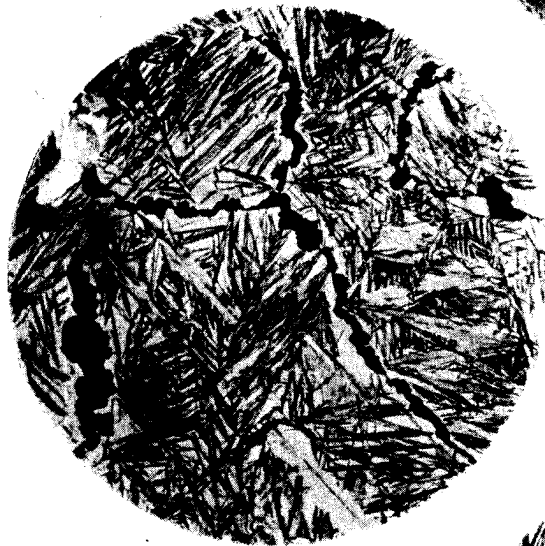
Рис. 28. -- Сплав 4 — 1,13% С; 7,25% Al. Закалка в воздухе от 1 160°С. Травление 2% ниталом 250 ×.
