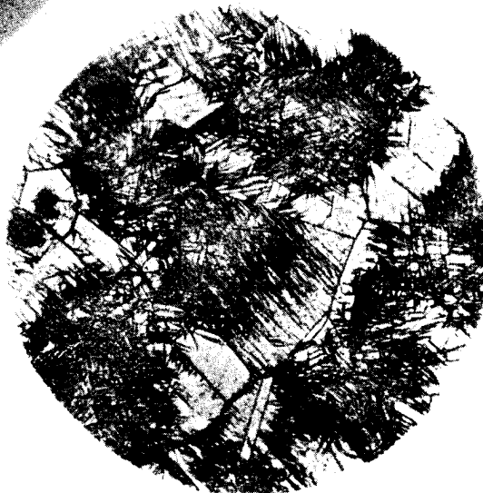
Рис. 35. — Сплав 27 — 1,62% С; 7,8% Al. Закалка в масле от 1160°С, с 3-х часовым отпуском при 400°С. Травление 2% ниталом 250 ×.
