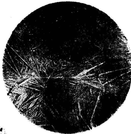
Рис. 27. — Сплав 5 — 1,35% С; 5,5% Al. Закалка в масле от 1 160°С. Травление 2% ниталом 250 ×.
