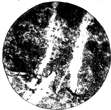
Фиг. 34. Доломит неравнозернистый с пятнистой микротекстурой, с закрытыми микротрещинами, выполненными битумом, которые рассекают трещины, заполненные минеральным веществом. Иркутский амфитеатр. Осинский горизонт усольской свиты (нижний кембрий). Бохан, скв. 1-Р, обр. 546.
