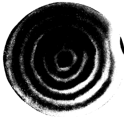
Рис. 2. Структура поля в непосредственной близости от пьезокерамической пластинки \varnothing 10 мм, f = 2,5 мгц
