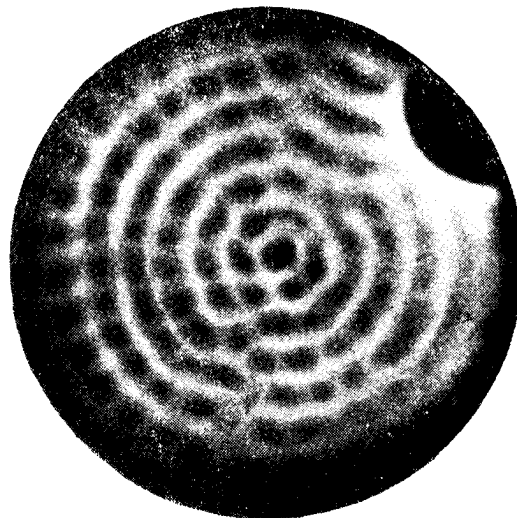
Рис. 3. Структура поля в непосредственной близости от пьезокварцевой пластинки \varnothing 50 мм, f = 3,0 мгц
