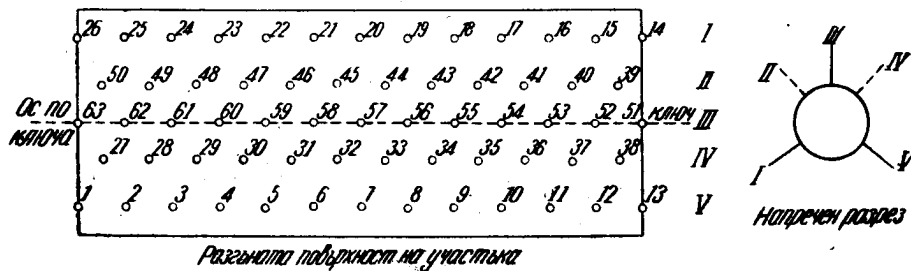
Фиг. 6—43. Схема за инжектиране на тунелен участък 25—30 м по метода на „редове“
