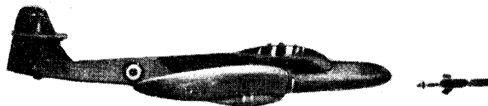
Рис. 62. Стрельба ночного истребителя NF11 «Метеор» экспериментальным управляемым реактивным снарядом фирмы Де Хавилленд
