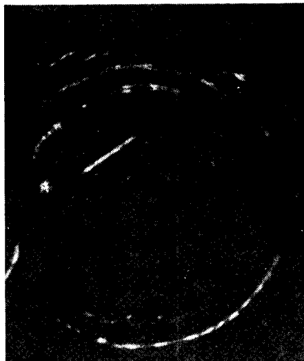
Рис. 28. След в камере Вильсона, образованный ядром, испытавшим удар нейтрона. Сам нейтрон, не обладая зарядом, следа не даёт
