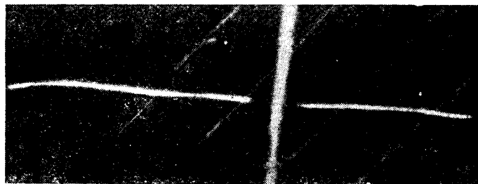
Рис. 43. Следы обоих осколков, получающихся при делении ядра урана. Широкая линия посредине — боковой разрез алюминиевой фольги толщиной 0,001 миллиметра. На фольгу был нанесён очень тонкий слой урана. По обе стороны фольги видны следы обоих осколков, разлетающихся в противоположных направлениях
