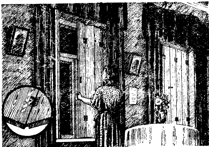
Рис. 25. Деревянные складные ставни
