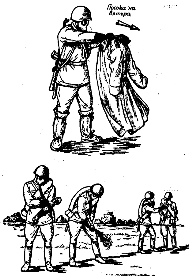
Фиг. 54. Някои начини за частична дезактивация на облеклото и снаряжението. Горѐ — изгърсване на ши- нел; долу — почистване на снаряжението и облеклото със снопчета сѐно или трева
