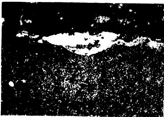
Bild 13 Beginnende Martensitbildung in der unteren Hälfte der Befunkungszone nach dem Anlassen
