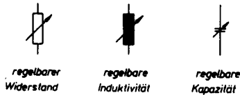
Bild 11 Schaltelemente zur Abbildung eines Netzes im Netzmodell
