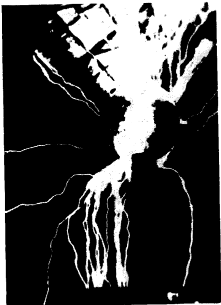
Bild 11 Glimmentladungen in Luft an einem Bandgenerator für 2,4 MV.
