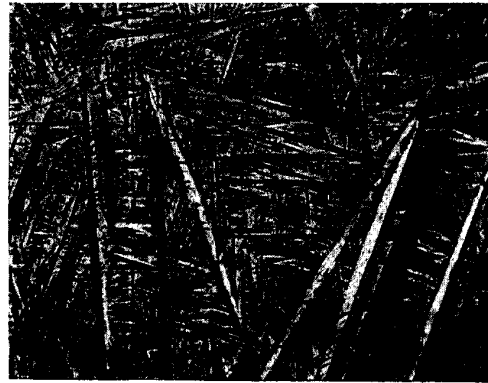
Bild 4 Martensitisches Gefüge bei der Legierung TiCr5Al 3.
