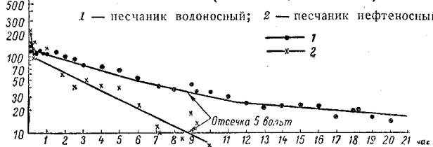
Рис. 2. Спад наведенной активности во времени для нефтеносного и водоносного песчаника (скв. 1238, Павловка)
