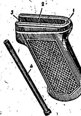
Фиг. 45. Ръчник (сб. 8): 1 — скоба за предпазване на ръчника от разцепване (8-2); 2 — гнездо за основанието на ръчника; 3 — улей за спусковата скоба; 4 — витло (0-19) на ръчника
