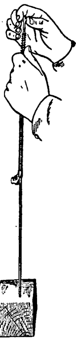
Фиг. 81. Сглобяване на възвратния механизъм
