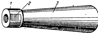
Рис. 8. Огнеприкривател: 1 — шийка; 2 — изрези за ключа; 3 — тръба
