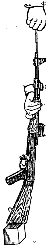
Фиг. 93. Чистене на канала на цевта
