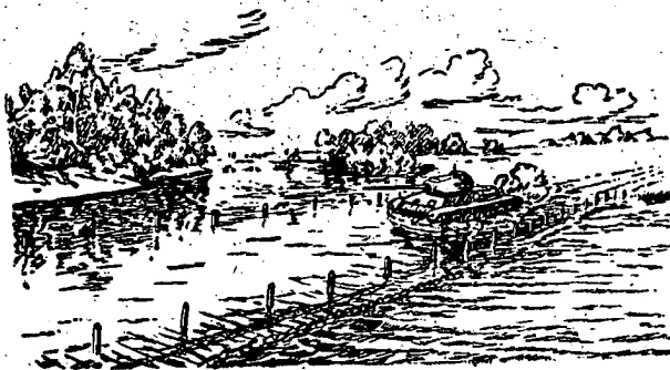
Рис. 35: Преминане на танк по подводен мост.
