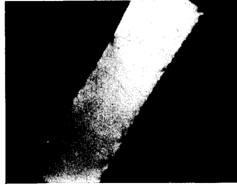
Bild 6. Schirmbildaufnahme von Reilit bei 960 m\mu zwischen gekreuzten Ultrarot-Polarisatoren
