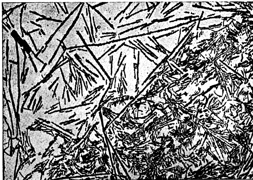
Obr. 4. Svar Pyroferalu. Různá hrubost karbidů ve svaru a základním materiálu.
