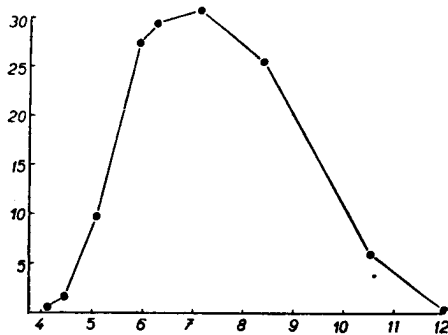
Obr. 3. Vliv pH kaseinového substrátu na aktivitu enzymu. Na ose x - pH 1% kaseinového substrátu, na ose y - proteolytická aktivita vyjádřená v \alpha \cdot 10^{-4} miliekvivalentů tyrosinu.
