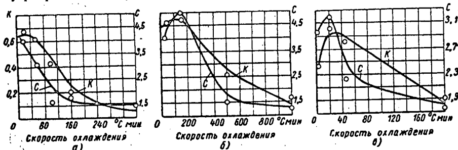
Фиг. 4. Зависимость микронеоднородности от скорости охлаждения: а — при различных температурах изложницы (сплавы Mg — Ca); б — при различных способах отливки (сплавы Mg — Mn — Al — Ca); в — при различных диаметрах земляных форм (сплавы Mg — Mn — Al — Ca).
