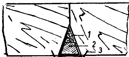
Obr. č. 30. 1 — těsnicí koudel, 2 — půvorek, 3 — žabka.
