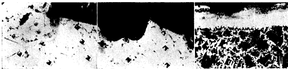
Obr. 8. 500× Místní difuze hliníku do oceli o 13 % Cr z povlaku. — Obr. 9. 500× Stejné místo jako na obr. 8. — Obr. 10. 200× Difuze hliníku do oceli St 5529 po žhání 900°/2 h.
