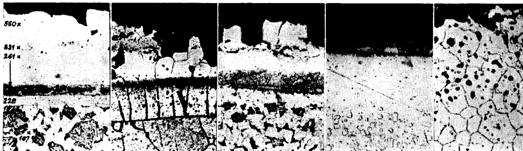
Obr. 14. 100× Obr. 15. 100× Obr. 16. 100× Obr. 17. 200× Obr. 18. 100× Obr. 14., 15. Difusní vrstvičky vzorků alitovaných v práškové směsi za teploty 900°/6 hod.: 13 % chromová ocel — obr. 15. obr. 14 — ocel C 35. — Obr. 16. Vliv deformace na alitovanou vrstvičku z obr. 14. — Obr. 17. Difuze hliníku do oceli o 25 % Cr při alitování v práškové směsi za teploty 900°/6 hod., pak 0,5 % HF. — Obr. 18. Alitovaná trubka C 35: Mikrostruktura u vnějšího povrchu při žhání 1300°/10 hod.
