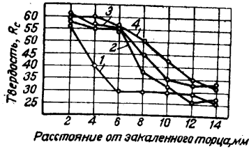
Рис. 16. Прокаливаемость сталей серии Ж с малыми добавками бора, ванадия и титана
