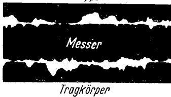
Bild 3. Oberflächenprofile von Tragkörper und Messer eines Rundmesserkopfes im Anlieferungszustand und nach betriebsmäßiger Belastung.
