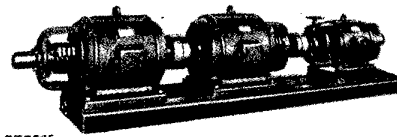
Bild 3. Tonfrequenz-Umformergruppe 20 kVA, bestehend aus Generator, Asynchronmotor und Frequenzumformer.
